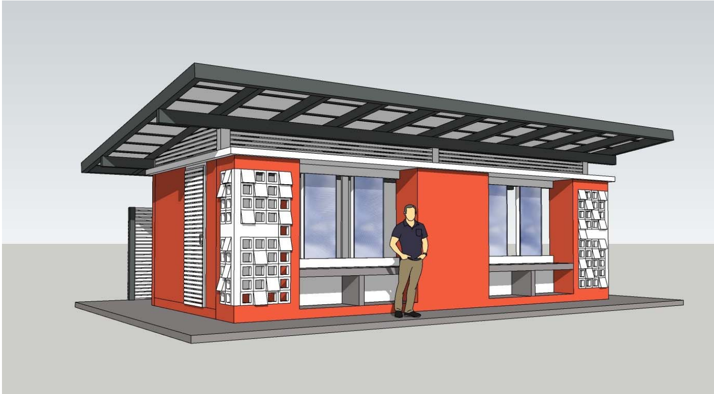
ห้องน้ำ-ห้องส้วมนักเรียนชาย 6 ที่/49 กรอบอาคาร 6.10 x 10.50 เมตร สูง 3.10 เมตร
